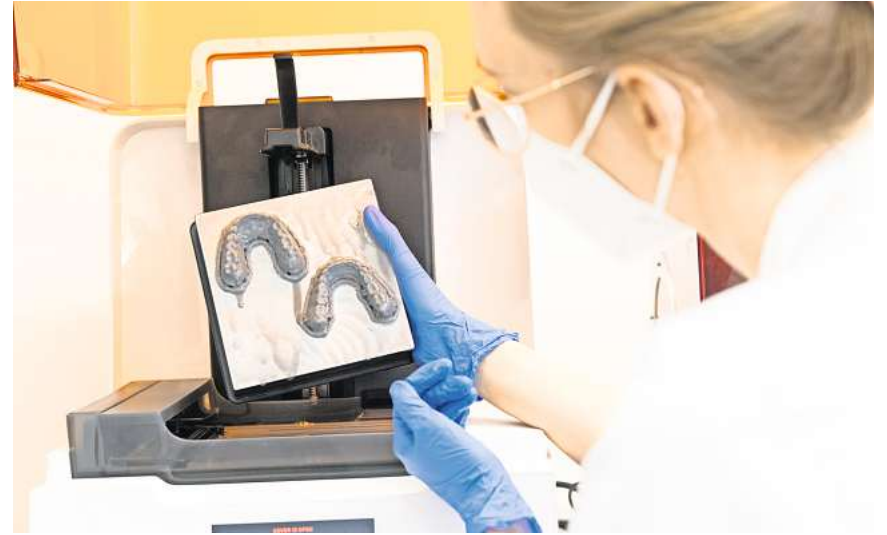
Zahnärztin Talisa Schwieder, Weiterbildungsassistentin bei Prof. Till Köhne, mit Modellen aus dem 3D-Drucker. Auf diesen Modellen werden dann die Aligner tiefgezogen. Die Plastikschienen sollen 22 Stunden am Tag getragen werden. Fotos: Stefan Straube
